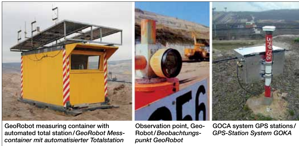
Fig. 8: Monitoring the mine-rim slopes in the opencast lignite mines of RWE Power AG (GeoRobot/GOCA systems) Abb. 8: Überwachung der Randböschungen in den Braunkohlentagebauen der RWE Power AG (Systeme GeoRobot/GOKA)
