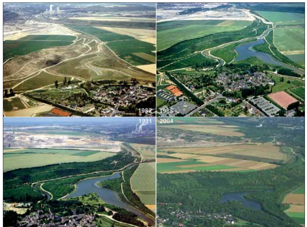
Fig. 4: Creation of Kasterer See (lake) with Kasterer Höhe (heights) high dump in the background Abb. 4: Herstellung des Kasterer Sees mit dahinter liegender Hochkippe Kasterer Höhe
