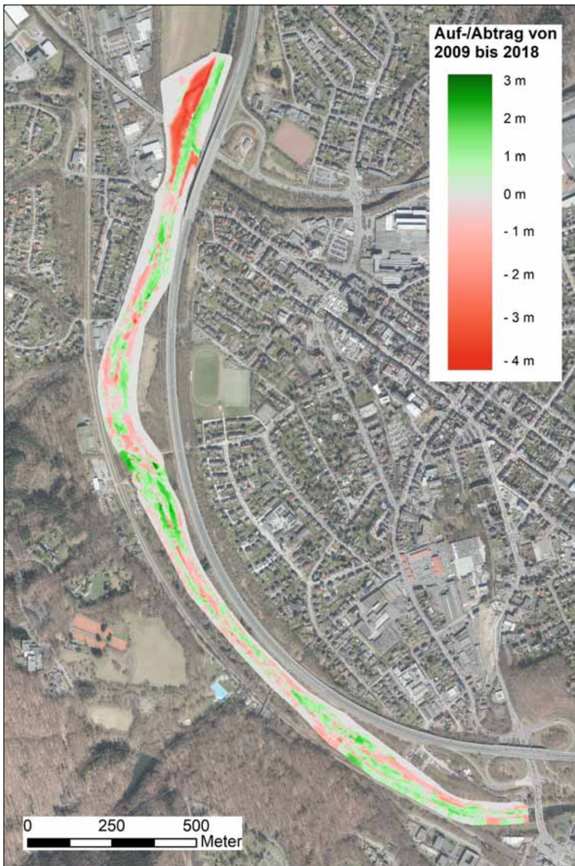
Abb. 2-7: Geländeauf- und -abträge im Bereich der Bauabschnitte I bis IV (Neheim-Binnerfeld) im gesamten Untersuchungszeitraum Datengrundlage: Land NRW (2020), Datenlizenz Deutschland - Namensnennung - Version 2.0 ( www.govdata.de/dl-de/by-2-0 )
