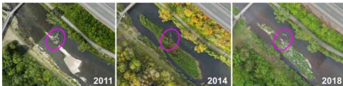
Abb. 2-31: Bauabschnitt I: Einbau eines Totholzstammes in der Mitte des Flusslaufes – Darstellung der Entwicklung im Umfeld in den Jahren 2011, 2014 und 2018
