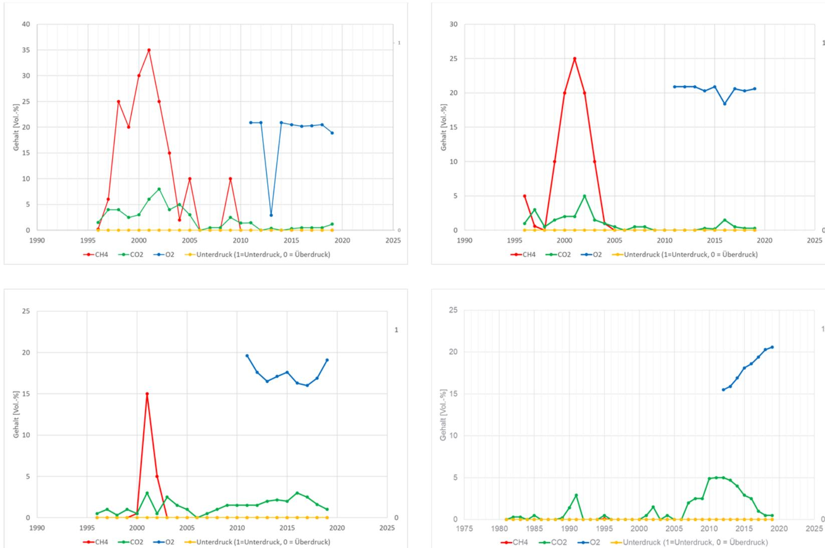
Abbildung 5: Entwicklung der Gaszusammensetzung an Schächten im Essener Süden
