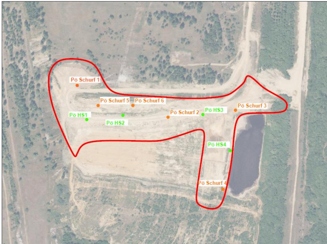
Abb. 8: Detailansicht der Bohrungen und Schürfe an der Kippstelle „Pösenberg“ mit Bezeichnung der jeweiligen Bohrung bzw. des Schurfs
