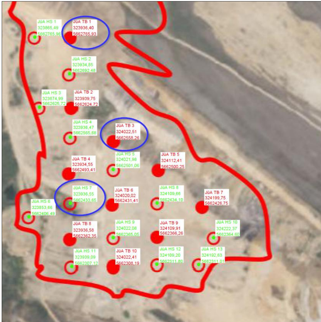
Abb. 5: Detailansicht der Bohrungen an der Kippstelle „Jüchen Alt“ mit Koordinaten und Bezeichnung der jeweiligen Bohrung (blaue Kreise: Bohrungen mit durchgehend auffälligen Analysenergebnissen hinsichtlich TOC, Sulfat und Schwermetallen)
