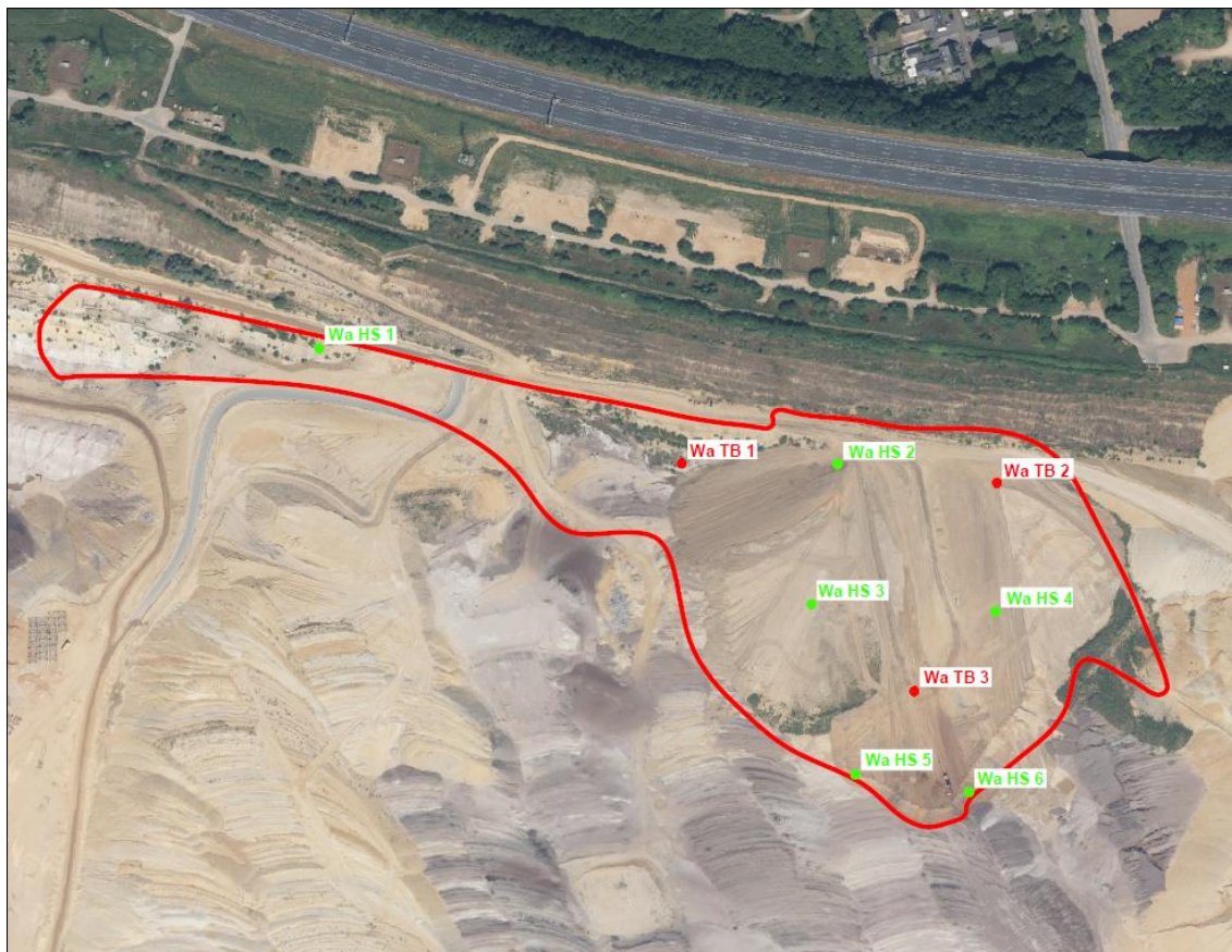
Abb. 7: Detailansicht der Bohrungen an der Kippstelle „Wanlo“ mit Bezeichnung der jeweiligen Bohrung
