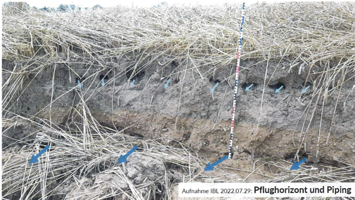
Abb. 15: Wasserwegigkeiten durch Pflughorizont (oben) und Piping (unten)
