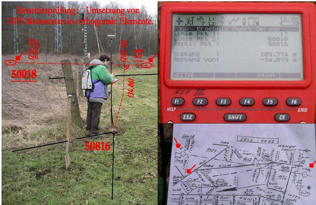
Abb. 4.1: Koordinatenbasierte orthogonale Identitätsprüfung
