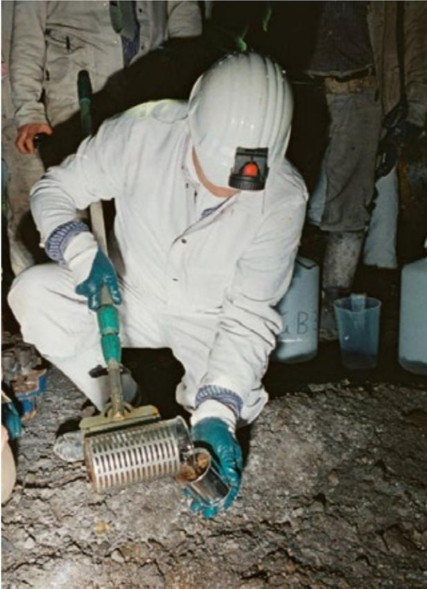
**Bild 7.3** – Gewinnung einer Schlammprobe unter Tage (Quelle: RAG AG)
