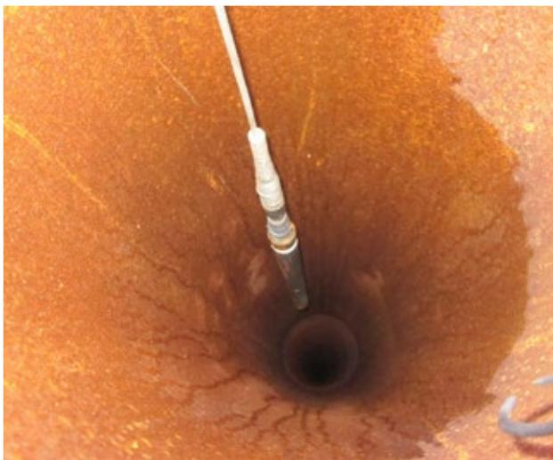
**Bild 7.2** – Gewinnung einer Wasserprobe in einem Lotungsschacht
