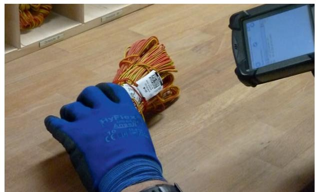
Bild 7.7 – Einscannen eines Zünderbündels (Standort Bergwerk Neuhoef-Ellers)
