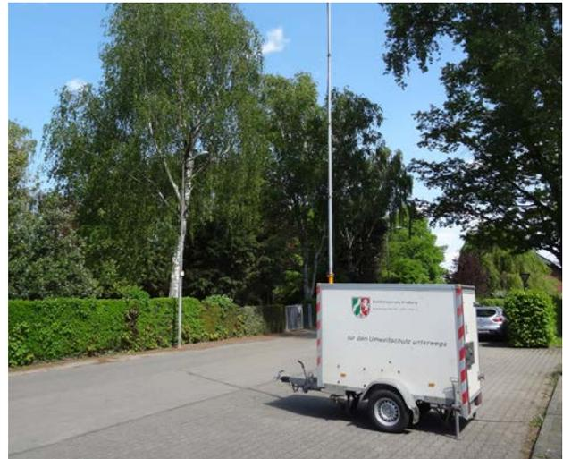
**Bild 13.1** – Messung mit der landeseigenen mobilen Langzeitgeräuschmessstation (Quelle: Bezirksregierung Arnsberg)
