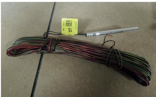
Bild 7.6 – Einzelne Zünder mit Matrixcode (Standort Bergwerk Borth)
