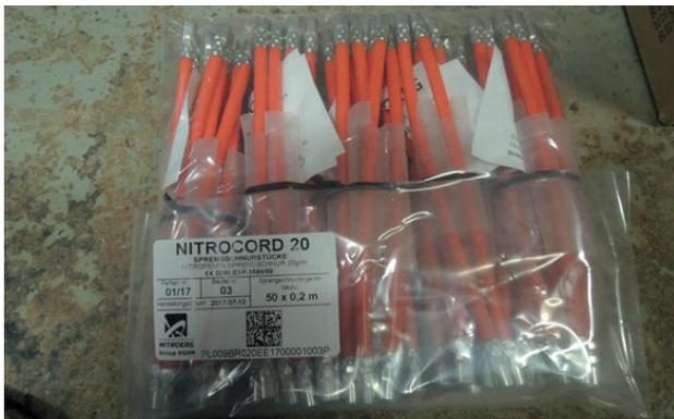
Bild 7.5 – Sprengschnurstücke mit Matrixcode auf der Verpackung (Standort Bergwerk Borth)
